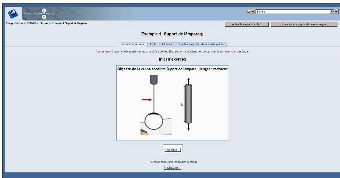
Figura 2. Objeto seleccionado y esquema de la fuerza a la que está sometido.
